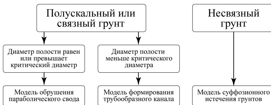
Рис. 3. Принципиальная схема определения расчетного диаметра карстовой деформации: полускальные грунты — разновидности скальных грунтов, наиболее подверженных к разрушению над карстовыми полостями ввиду низких прочностных свойств; связные и несвязные грунты — подклассы дисперсных грунтов, характеризующихся принципиально различными механизмами разрушения над карстовыми полостями. Дальнейшее их разделение по генезису и физико-механическим свойствам определяет только скорость деформирования над подземными пустотами. Критический диаметр — диаметр полости, при котором произойдет обрушение грунтового слоя
