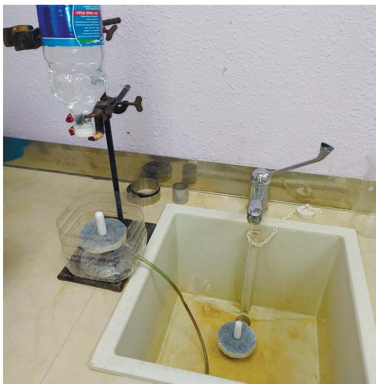
Рис. 1. Установка моделирования свай под ангидритами (слева изображен образец № 2, справа – № 1)
