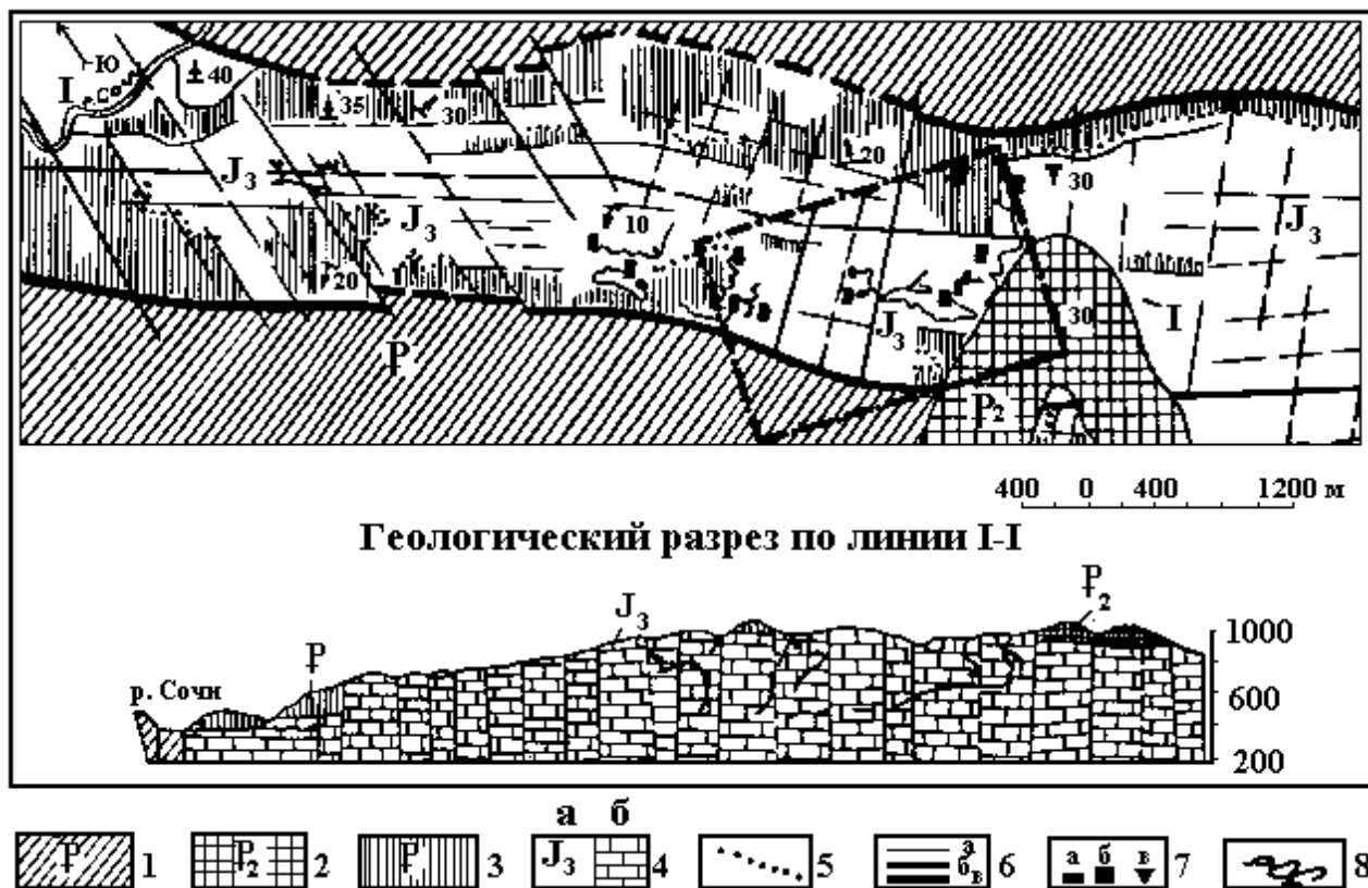
Рис. 3.10. Карстолого-геологическая схема и геологический разрез массива Алек (по В.Н. Дублянскому и др.,1980).1-поля развития аргиллитов,алевролитов и глин палеогена; 2-останец надвигового тела, сложенного серией аргиллитов, алевролитов и глин; 3-участки развития покрытого карста под отложениями палеогена; 4-участки голого и задернованного карста на массивных, толсто- и среднеслоистых известняках верхней юры: а-на плане, б-на разрезе; 5-стратиграфические контакты; 6-разломы: а-четвертого и третьего порядков, б-второго порядка,в-первого порядка; 7-входы в карстовые полости: а-колодец-понор, б-шахта-понор, в-пещера-источник; 8-подземные ходы и залы. Штрихпунктирной линией обозначен район детальных исследований тектонических трещин (рис. 3.11)
