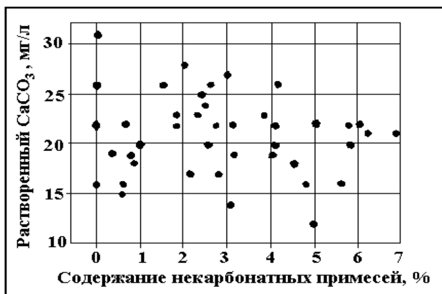
Рис.2.2. Растворимость (за 28 часов) известняков в зависимости от содержания в них некарбонатных примесей (по Л. Якучу, 1979)
