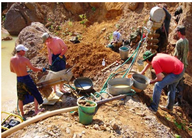
Сборная полевая обогатительная установка в полевых условиях
