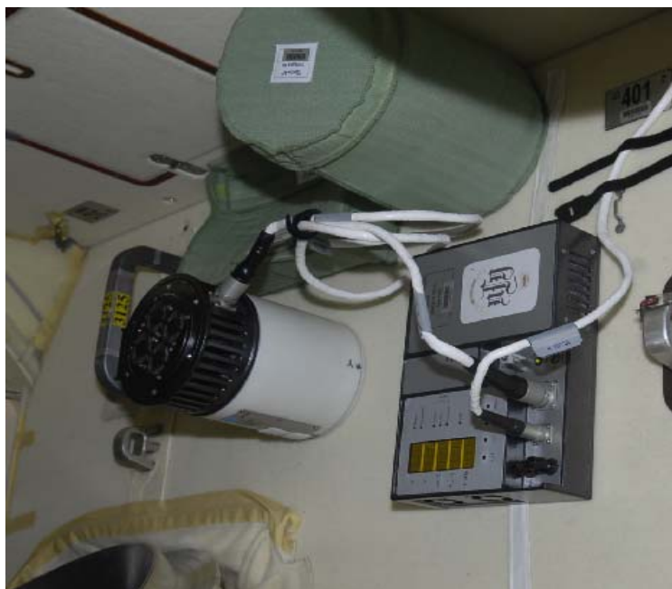
Прибор «Дакон-М» на РС МКС. Слева – датчик конвекции ДК; справа – блок управления и сбора данных БУСД, вверху – чехлы для ДК и БУСД
