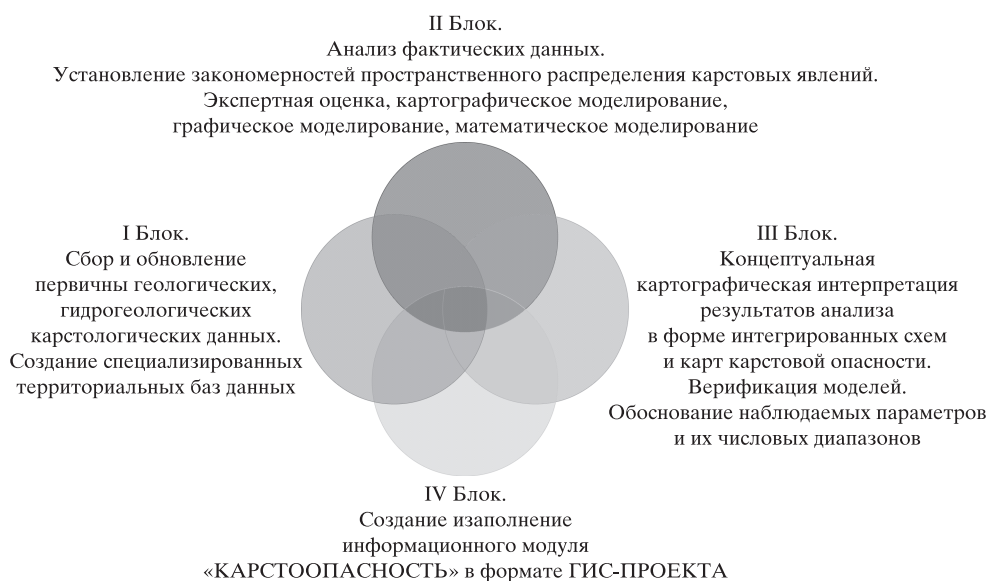
Рис. 2. Основные функциональные элементы системы карстомониторинга.
